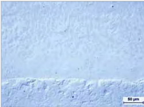
Хим. связь покрытия Ultraplate и штока поршня Bonding of Ultraplate to piston rod
