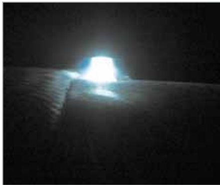
Процесс сварки дуговой плазмой Р.Т.А. и технология двойной сварки Р.Т.А. P.T.A.-process as well as P.T.A. Twin technology
