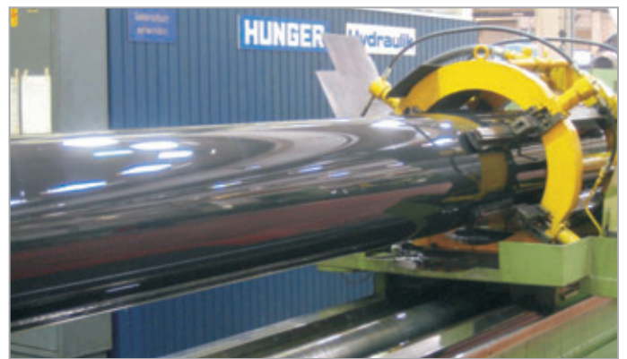
Oberflächenbearbeitung eines Gießzylinderplungers auf einer Horizontal-Außenhonmaschine Surface treatment of a casting cylinder plunger on an horizontal honing machine
