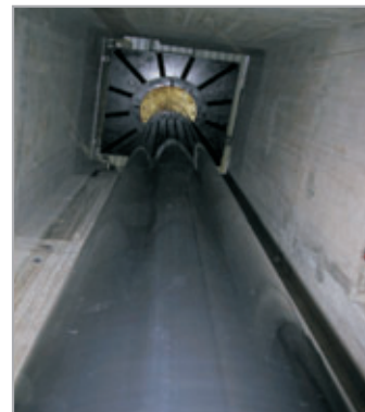
Links Kolbenstange mit Ceraplate-Beschichtung
