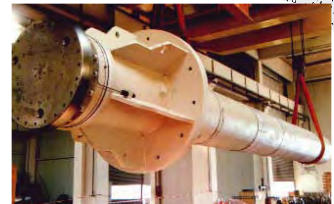
Vertikalgießzylinder für den Aluminiumstrangguss Rechts im eingebauten Zustand schematisch dargestellt
