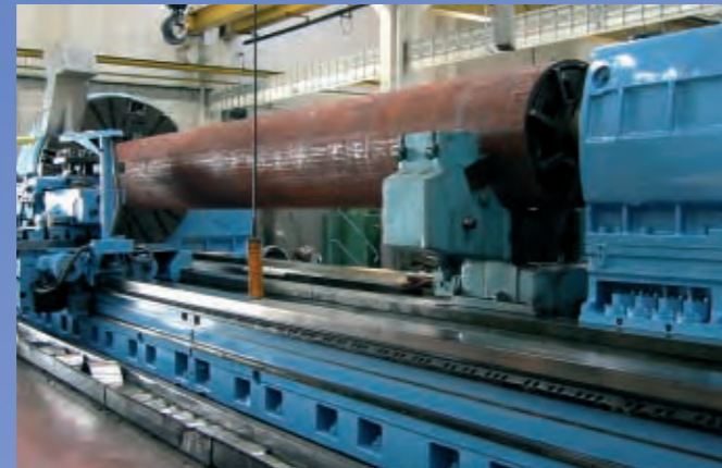
Drehbearbeitung von Großteilen mit Abmessungen bis zu 4 m Durchmesser und 25 m Länge.
