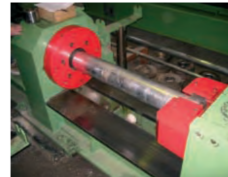
Ziehen eines Rohres
