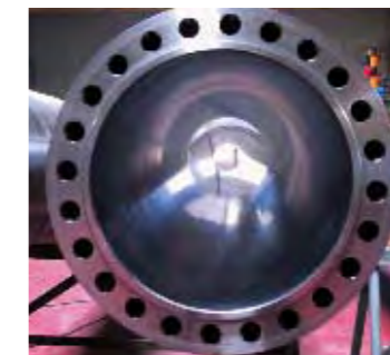
Durch Honen bearbeitete Oberfläche eines Zylinderrohres
