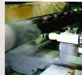
MPC®-Kunststoffbeschichtung einer Kolbenstange
