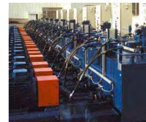
Die modernen Antriebe verfügen über hydraulische Steuer- und Sicherheitsblöcke, mechanische und elektronische Wegmeßsysteme sowie automatische Verriegelungseinrichtungen.
