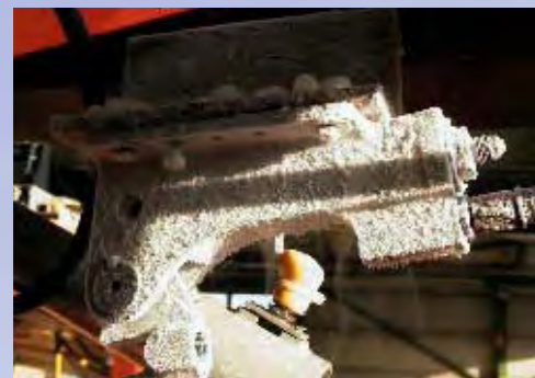
Verriegelungshaken für Fahrwerk bei -54°C Tieftemperatur
