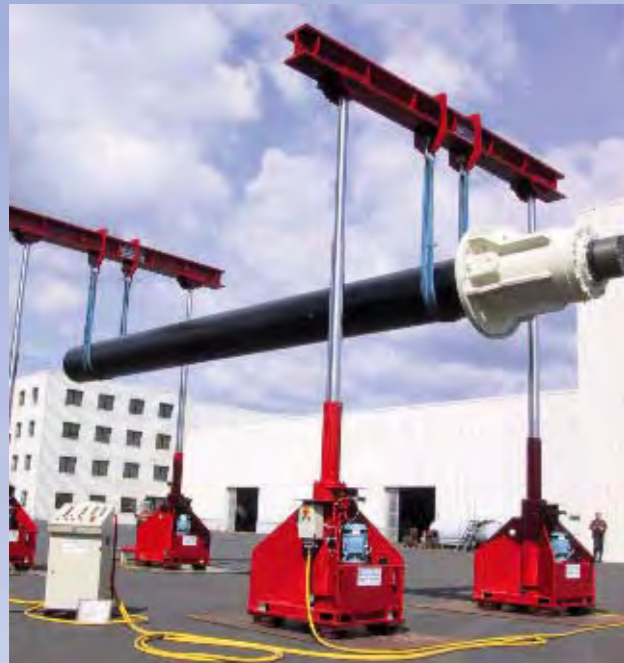
Hydraulisches Liftsystem mit 100 Tonnen Hubkapazität
