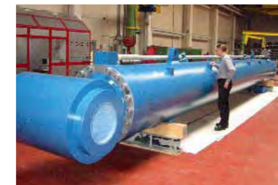
Pfahlramme zur Gründung von Brückenpfeilerfundamenten oder bei der Anlage von Kaianlagen für einen chinesischen Kunden
