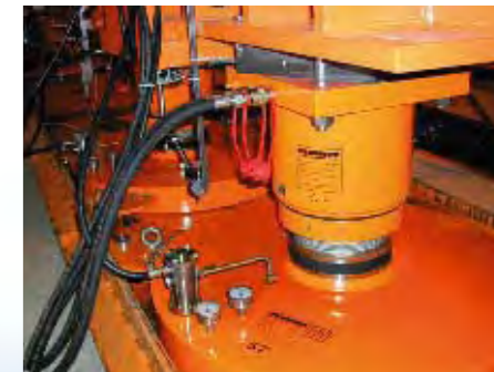
Hubzylinder mit Luftkissenheber
