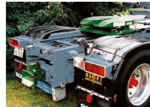
Wartungsfreie Sattelkupplung und vollhydraulische Anhängerkupplung.
