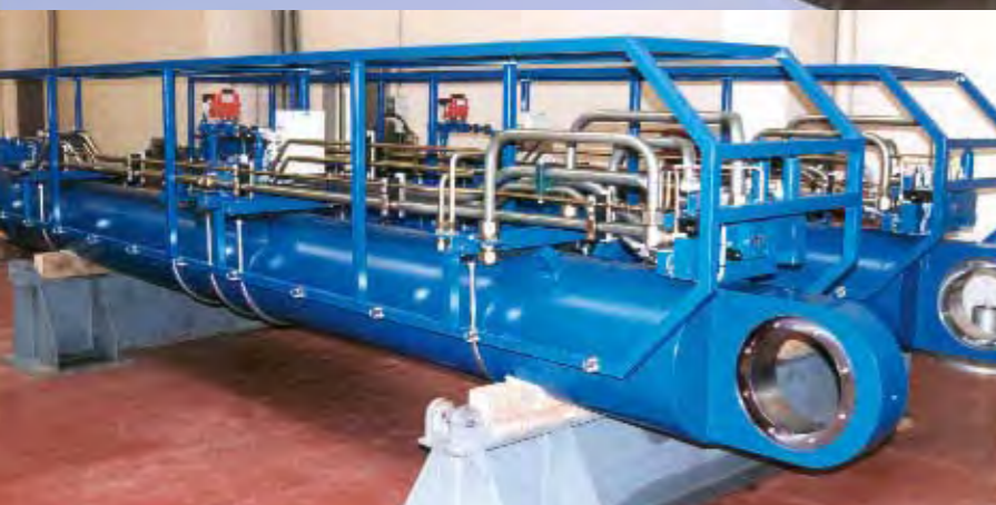
Klappbrückenzyylinder mit aufgebauten hydraulischen Steuerungs- und Sicherheitselementen
