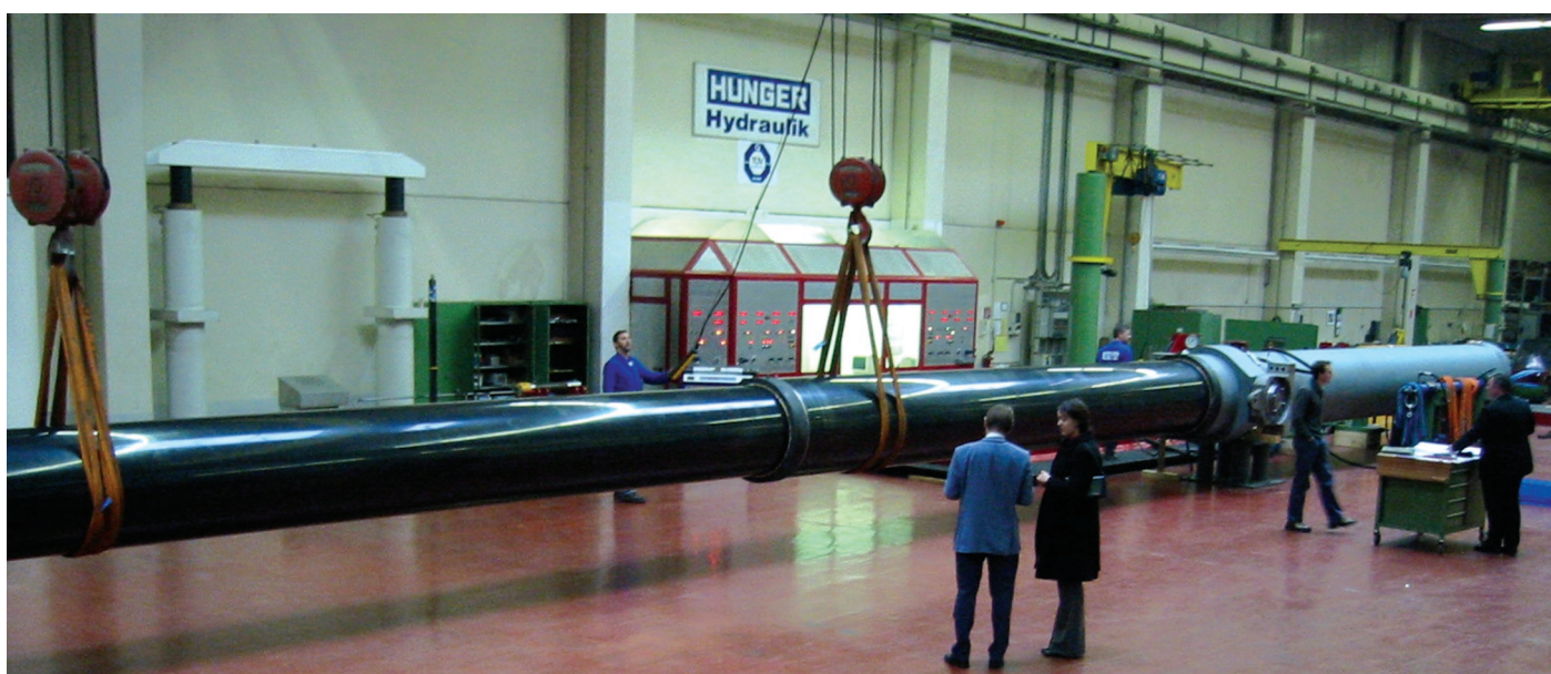
6: Montage eines Teleskopzylinders mit Ceraplate 2000 Beschichtung und 18 m Hub
