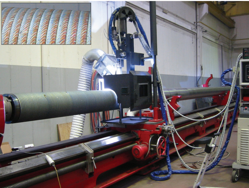
7: P.T.A.-Auftragsschweißen an einer Kolbenstange
