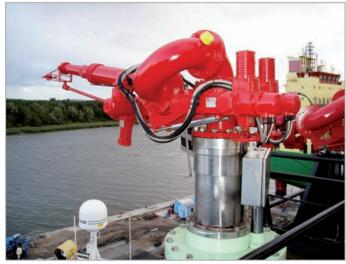
Die Auslegung des Feuerlöschmonitors richtet sich nach dem erforderlichen Löschmitteldurchsatz, dem verfügbaren Löschmitteldruck, der Wurfweite, der Art des Löschmittels bzw. der Löschmittelzusätze und der Betätigungsart.
