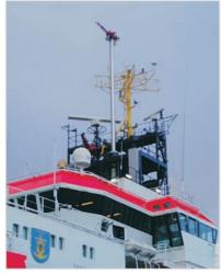
**SUBS Arcona:** 3 x Feuerlöschmonitore, davon 1 x teleskopierbar bis 30 m über Wasserlinie sowie ein teleskopierbarer Monitor mit 600 m<sup>3</sup> / h und Wurfweite von 120 m 3 x Fire fighting monitors, of which is 1 x telescopeable to 30 m above water line as well as one telescopeable monitor with  $600 \, \text{m}^3 / \text{h}$  and a throw distance of 120 m
