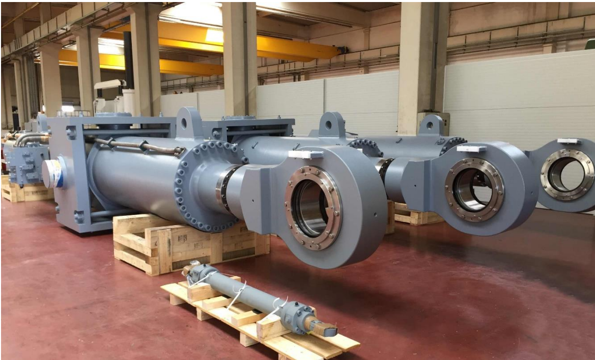
Boston-Barrier Hydraulikzylinder, versandbereit
