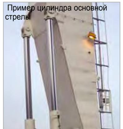
Сертификация в соответствии со стандартом DNV для подъемных устройств 2008, стандартом DNV для сертификации гидроцилиндров № 2.9 и стандартом DNV для морских устройств E101/D101 или альтернативно в соответствии с положениями ABS по сооружению и монтажу стальных судов. Часть 4, регистр Ллойда, германский регистр Ллойда или сертификационная компания Bureau Veritas.
