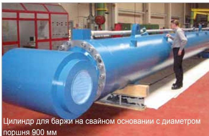
Цилиндр для баржи на свайном основании с диаметром поршня 900 мм
