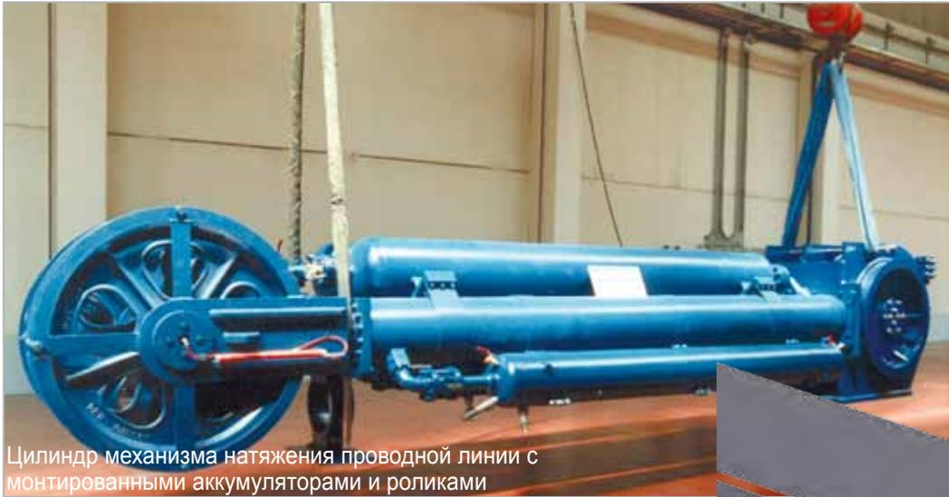
Цилиндр механизма натяжения проводной линии с монтированными аккумуляторами и роликами
