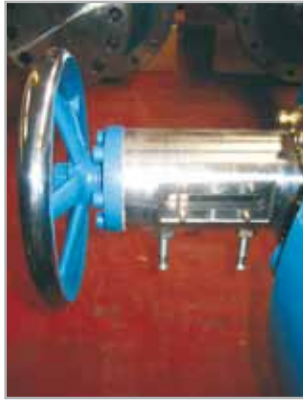
Гидроцилиндр с механическим устройством блокировки верхней конечной позиции, оптическим индикатором положения и устройством контроля с помощью концевого выключателя Hydraulic cylinder with mechanical locking device for retracted position, optical position indicator and limit switches
