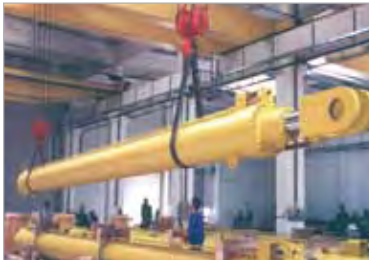
Гидроцилиндр длиной выпуска в 35 м, с покрытием Ceraplate для подъемного моста Канарской пристани, Соединенное Королевство
