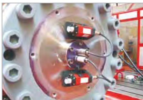
Гидроцилиндры для гидротехнических сооружений с индикаторным штоком для определения позиции и регулируемые выключателями для конечных позиций
