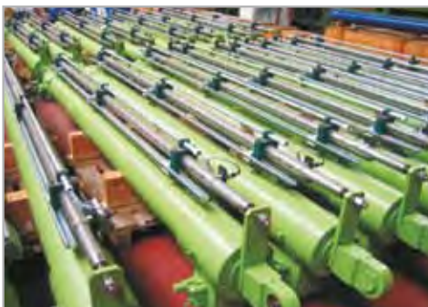
Гидроцилиндры для гидротехнических сооружений с индикаторным штоком для определения позиции и регулируемые выключателями для конечных позиций
