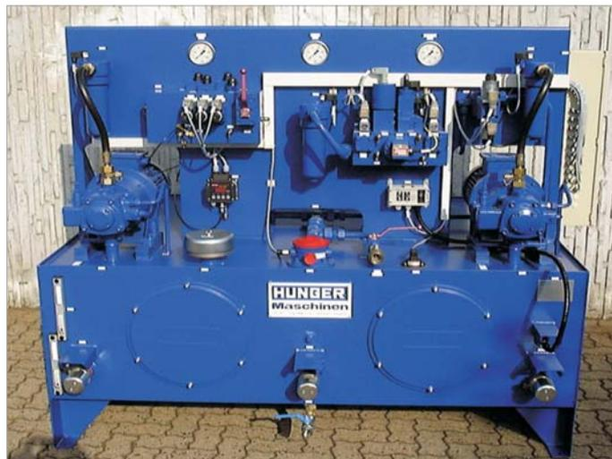
Гидроагрегат для разливочной установки, в котором панель управления расположена над масляемкостью, для повышения компактности всего оборудования
