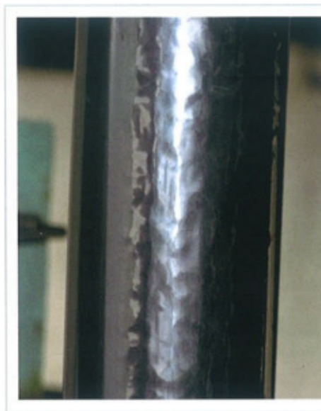
Bild 2: Unterrostung einer Metalloxidbeschichtung; hier an der Südseite der Kolbenstange (Fotos: Hunger) Fig. 2: Under-film rusting of a metal oxide coating; here on the south side of the piston rod (photographs: Hunger)
