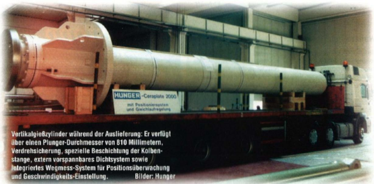
Vertikalgießzylinder während der Auslieferung: Er verfügt über einen Plunger-Durchmesser von 810 Millimetern, Verdrehsicherung, spezielle Beschichtung der Kolbenstange, extern vorspannbares Dichtsystem sowie integriertes Wegmess-System für Positionsüberwachung und Geschwindigkeits-Einstellung. Bilder: Hunger
