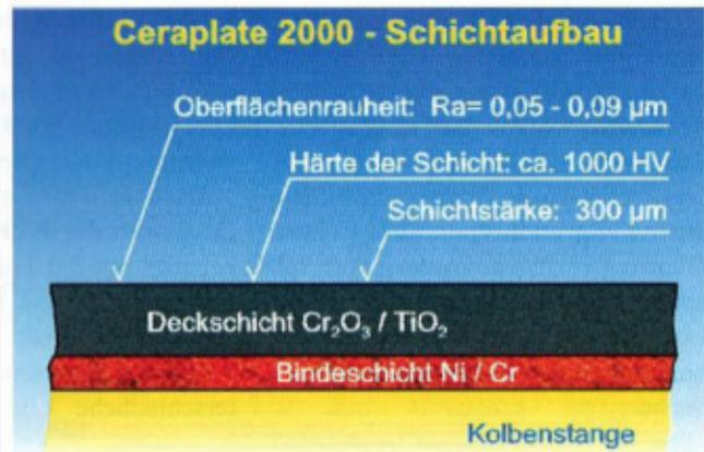
Schichtaufbau der Metalloxid-Beschichtung Ceraplate 2000: Der Zweischichtaufbau schützt die Oberfläche der Kolbenstange vor Korrosion und mechanischem Verschleiß.
