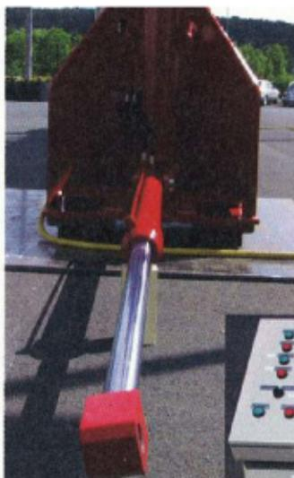
**Hydraulikzylinder des Fahrtriebels: lastunabhängige Geschwindigkeitseinstellung über Stromregelventile.**
