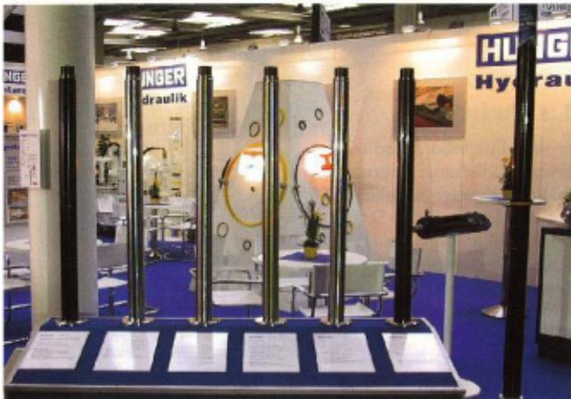
Stahlwasserbauzylinder mit Beschichtung 'Ceraplate 2000'.
